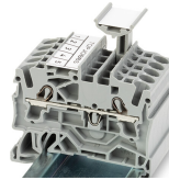
TOPJOB*S-Gruppenschildträger (2009-193) hier bestückt mit Beschriftungsstreifen, verwendbar für alle TOPJOB*S-Reihenklennen der Serien 2000 bis 2016. Nicht über eine Abschlussplatte hinweg setzen!
