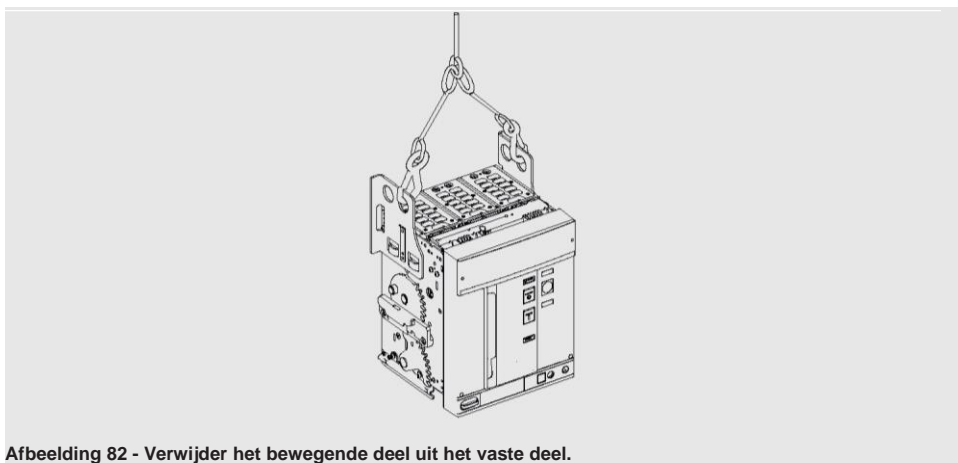
Afbeelding 82 - Verwijder het bewegende deel uit het vaste deel.
