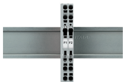
Sicherungsklemmen mit 6,2mm-Klemmenbreite können direkt aneinander gereiht werden. Am Ende der Klemmenleiste, oder wenn keine Sicherungsklemme folgt, ist eine Endplatte für Sicherungsklemmen zu verwenden.
