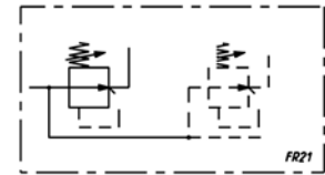
FR21 = Reduktor do montażu blokowego bez odpowietrzenia bez manometru
