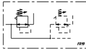
FR19 = Reduktor do montażu blokowego z odpowietrzeniem, bez manometru
