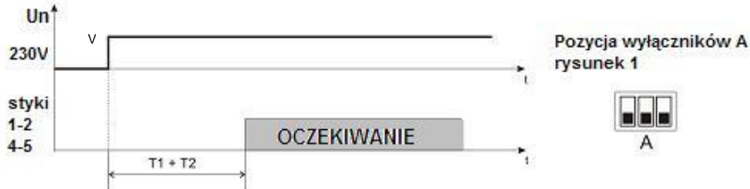
Rysunek 2 - Algorytm opóźnienia załączenia
