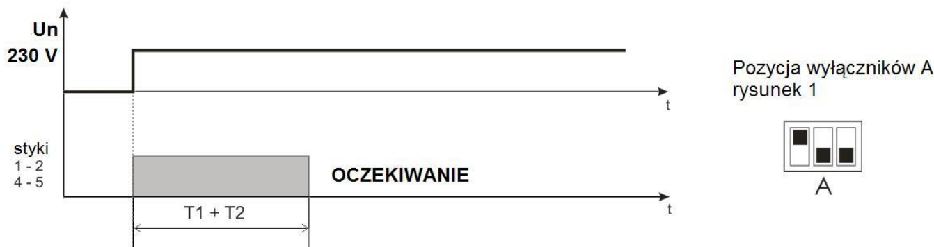
Rysunek 6 – Algorytm pracy przełącznika "Impulsowy 2"
