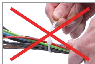
1.3 - Unikać przeginania opaski, nie poprawia to siły mocowania a może uszkodzić opaskę
