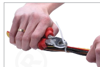
1.4 - Odciąć wystającą część opaski za pomocą szczypic, zostawiając kilka mm jako zabezpieczenie
