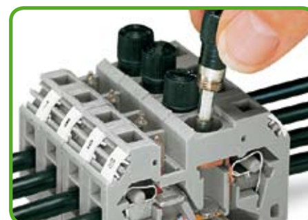
W przypadku przepalenia wkładki bezpiecznikowej należy wykroć uchwyt i wymienić wkładkę.
