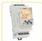
SHT-1, SHT-1/2 SHT-1: zegar sterujący z programem dzień, 1 tygod., 1-kanalowe, wyjście CO 16A, SHT-1/2: funkcje jak w SHT-1, wyjście 2-kanalowe, str. 22
