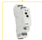
PRI-51 Pomiar poprzez wbudowany transf. prądu, 5 zakresów (w wariantach 1/2/5/8/16 A), zakres 5 A nadaje się do transf. prądu (X/5), zasilanie oraz wyjście jak w PRI-32, różnice: pomiar bezpośredni oraz dokładniejsze zakresy (wyższa czułość) = dokładniejsze pomiary. str. 81
