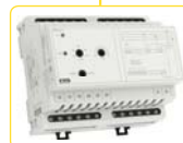
PRI-53 Do nadzoru prądu w urządzeniach 3-fazowych, zasilanie 24-240 V AC/DC, odseparowany galw., od obwodu nadz. prądu, 2 typy wg wielkości prądu znamionowego In (1 A, 5 A). str. 83
