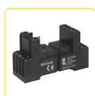
ES-15/4N - gniazdo Prąd max.: 12 A, waga: 59 g, Montaż na szynie DIN Do przełączników 4-stykowych str. 34
