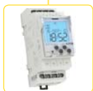
SHT-6 cyfrowy zegar sterujący z sygn. DCF. Harmonogr. dzień, tygod., roczny wyjście 16 A, 1-kanalowy, str. 24
