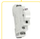
PRI-32 Pomiar poprzez transformator prądu (przewód w otworze, odsepar. galw., bez strat ciepła), prąd ustaw. 1-20 A, zasilanie UNI 24 - 240 V AC, 24 V DC, wyjście CO 8 A. str. 80
