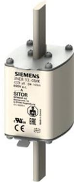
SITOR-Sicherungseinsatz, mit Messerkontakten, NH2, In: 550 A, aR, Un AC: 690 V, Un DC: 440 V, Stirnkennmelder
